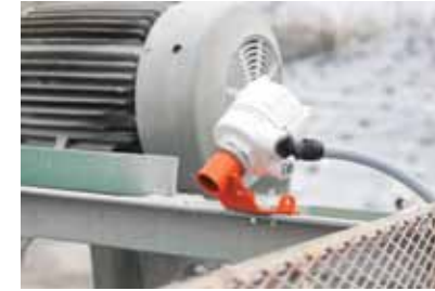
Şekil 6: Duruşlar sırasında ya da boş çalışırken ucu geri çekmek için sensörler kullanılıyor. Figure 6: Sensors are used to back the blade away during stoppages or when running empty
