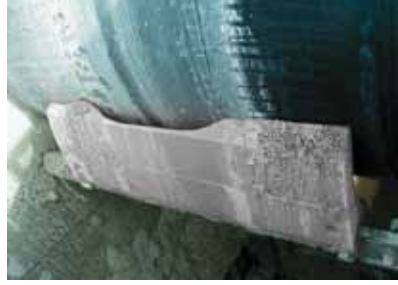
Şekil 2: Ucun merkezi eşitsiz biçimde aşındıkça dış kenarlar “gülen yüz” ya da “hilalleşme” denilen bir etki yaratır. Figure 2: As the center of the blade wears unevenly, the outer edges create an effect called a “smiley face” or “mooning.”
