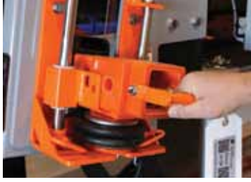
Şekil 7: Her bant sıyrıcı gerdirme sisteminde servis kolaylığı ana unsurlardan biri olmalıdır. Figure 7: Ease of service should be a key element in any belt cleaner tensioning system.
